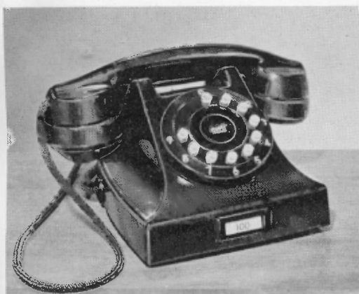
Fig. 4 X 2324 Knappsatsapparat typ DBH 16 för tonimpulsering
